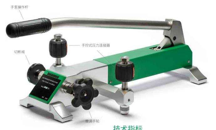
PGPH是一款手动气压高压台式泵。该泵既可以高效地产生真空,又可以快速省力地产生高达14MPa的高压,一分钟内就可以轻松地达到最大压力。PGPH泵配有腔体控制装置,提供了出色的压力微调能力,具有两个手动即可拧紧的输出口,可以快速便捷地连接,无需任何工具。
