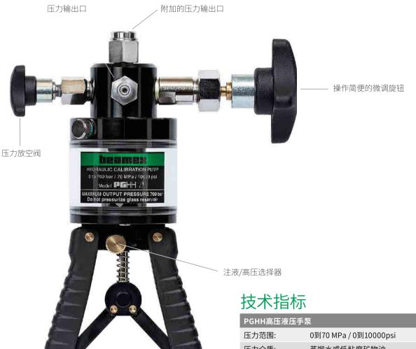
PGHH是一款手动高压液压泵,可以兼容多种介质(如矿物油,蒸馏水等)。手泵配有腔体控制装置,提供了出色的压力微调能力。PGHH还包括一个注液/高压选择器,便于使用。
