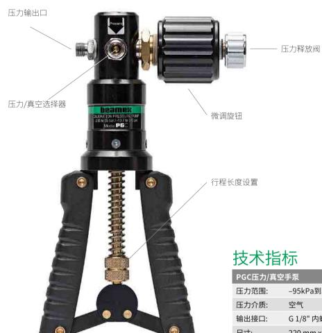
PGC手泵,可以产生压力或者真空。使用压力/真空选择器,快速进行压 力/真空选择。微调装置提供了精确地压力控制。
