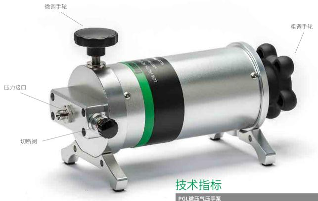
PGL是一款手动微压气压台式泵。该泵具有绝热的腔体,从而在校准期间减少了环境温度变化的影响。采用螺纹操作的腔体控制和微调旋钮,可以达到非常准确和稳定的压力控制效果。
