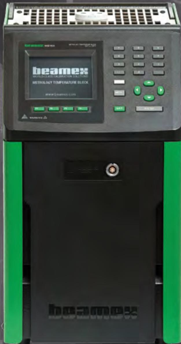
工业现场用便携式干式温度校准炉
